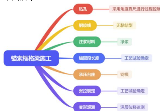
图 1-1 锚索施工控制要点
