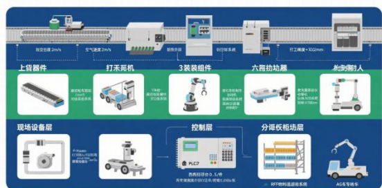
图 1 基于 PLC 的机电一体化自动化生产线系统组成示意图
