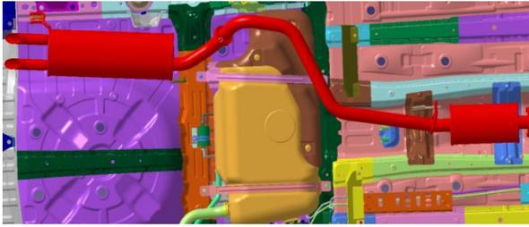
图1 主、副消声器底盘空间布置简图
