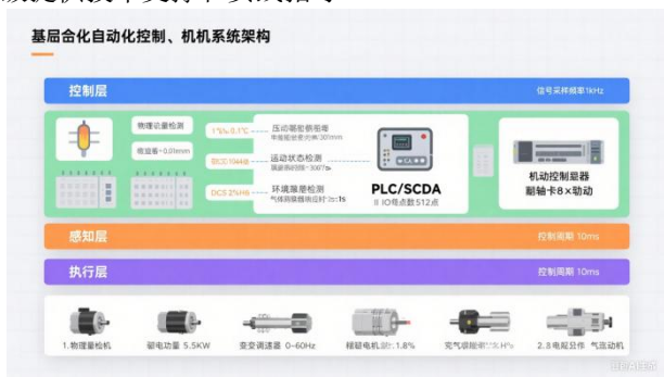
图 1 基于自动化控制的机电系统架构示意图
