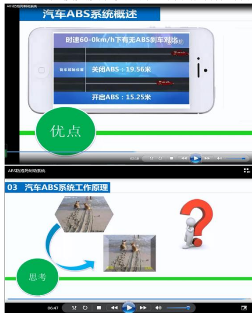
图 1 有无 ABS 系统区别对比
