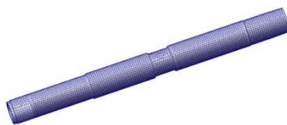
图 2 除垢工具中心轴网格模型
