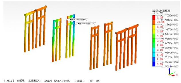
图 5-3 高架桥墩纵桥（Z 向）水平位移云图
