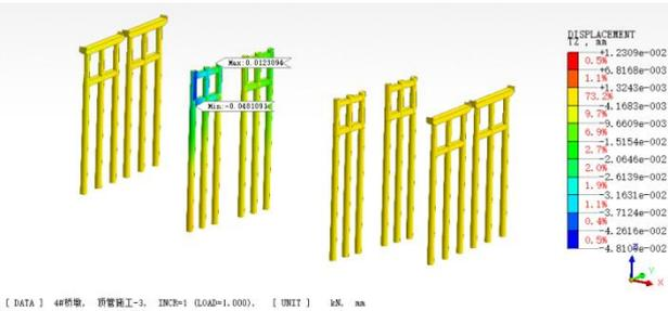
图 6-3 高架桥墩纵桥 (Z 向) 水平位移云图
