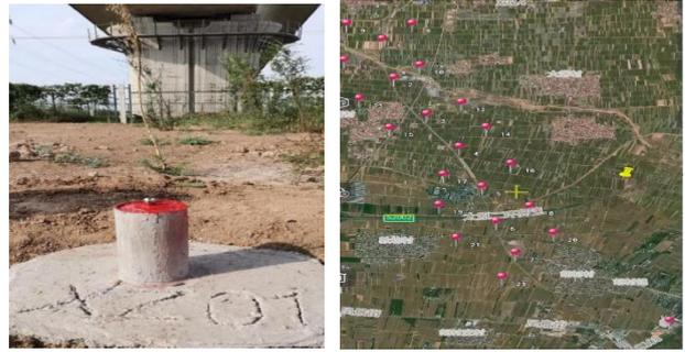
图 1 地面控制点沉降监测点位 图 2 沉降观测点位布设示意图
