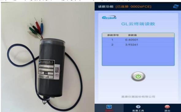
图 4 地基分层监测位移计及软件
