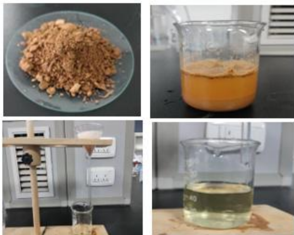
图 2 制取红壤滤液流程图
