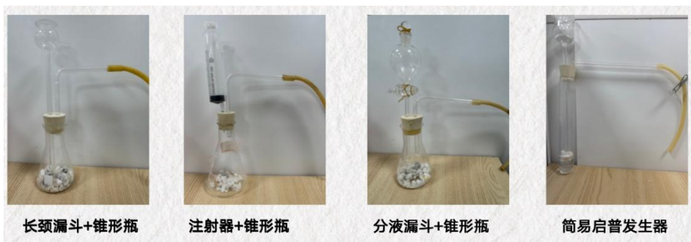
图 3 制取二氧化碳的发生装置
